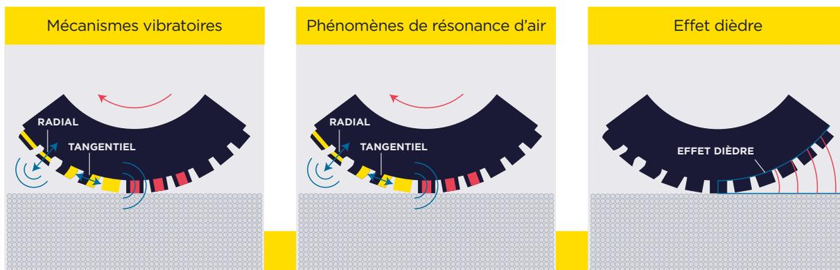
Figure 1 Les principaux mécanismes de génération des bruits de roulement
